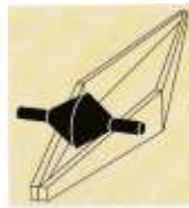
Abb. 2: Ein Doppelkegel schwingt um die Mittelachse des Doppelkegels hin und her und dreht sich im dichtesten Punkt um sich.
